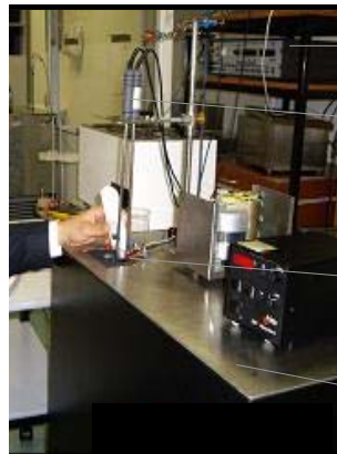
Şekil 5. Kulak Termometrelerinin Kalibrasyon Düzeneği
