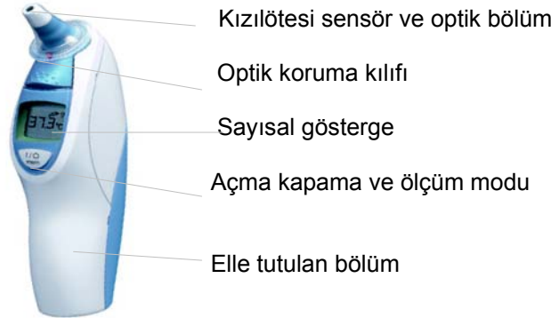
Şekil 2. Tipik Bir Kızılötesi Kulak Termometre Yapısı
