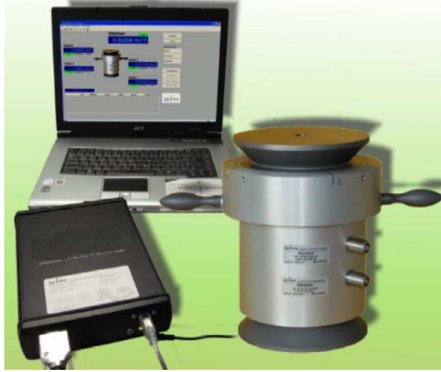
Şekil 2. Kalibrasyon Referans Kuvvet Dönüştürücünün Önden Ve Üstten İşaretleme Noktalarının Gösterimi
