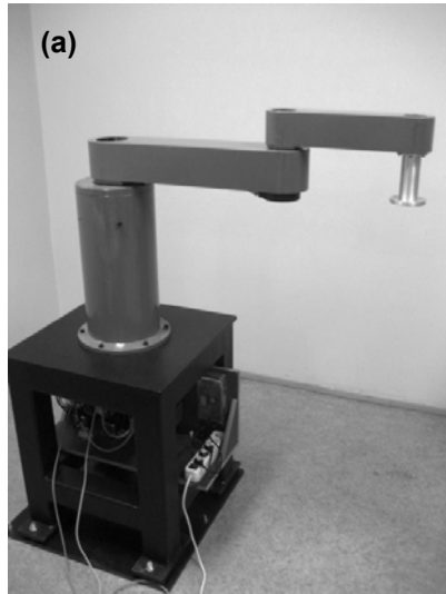
Şekil 2. DEU-S45-900 Robot Manipulatörü ve Kinematik Çalışma Uzayı.
