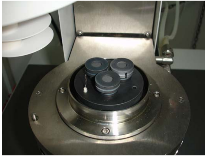
Şekil 3. Netzsch LFA 457 Test Cihazı ve Numuneler
