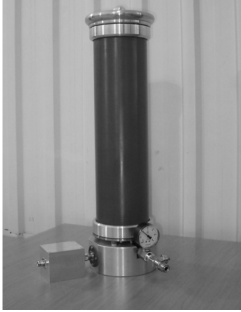
Şekil 2. 100 kV AC yüksek gerilim bölücüsü[5]
