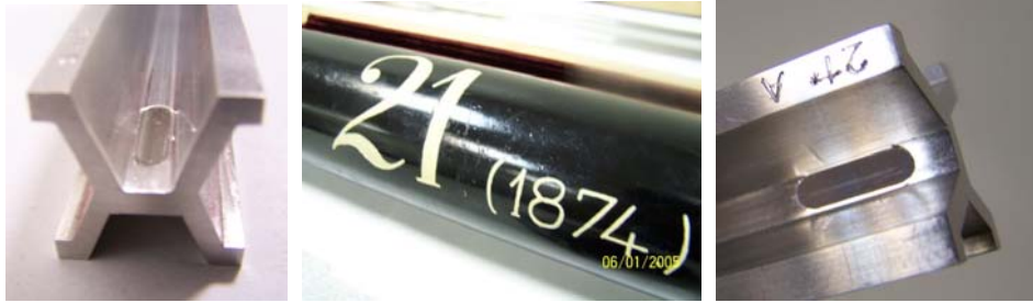
Şekil 1. TÜRKİYE 21 no'lu Ulusal Metre Prototipi görünümü
