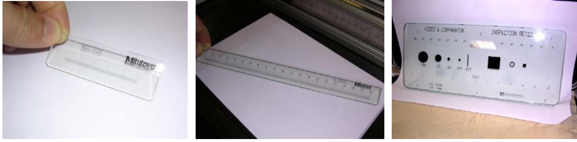
Şekil 4. Tek ve İki boyutlu cam skala örnekleri
