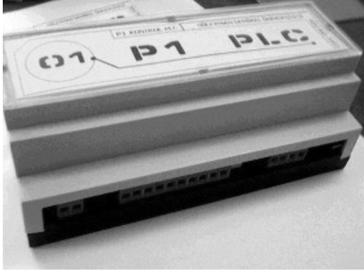
Şekil 4. Pompa kontrol PIC PLC P1
