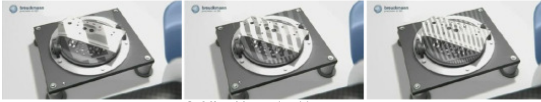
Şekil 5. Yapısal ışıkla tarama
