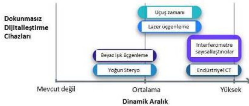
Şekil 18. Farklı dokunmasız yöntemlerin dinamik aralık/parça yansıtma özelliği açısından karşılaştırılması [16]
