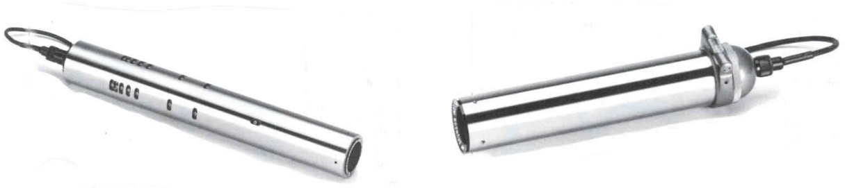
Şekil 12. Laboratuvar ölçümlerinde kullanılan çok ve tek hedefli kolimatörler [2]
