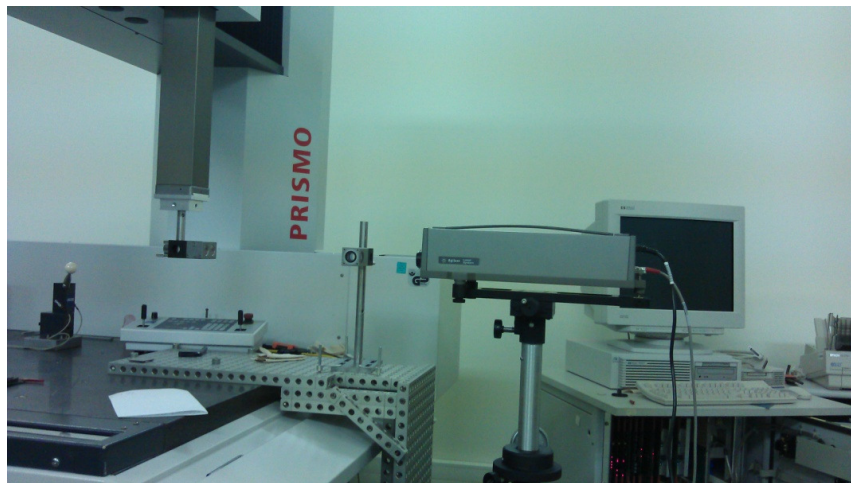
Şekil 2. Lazer Interferometre ile CMM skala kalibrasyonu
