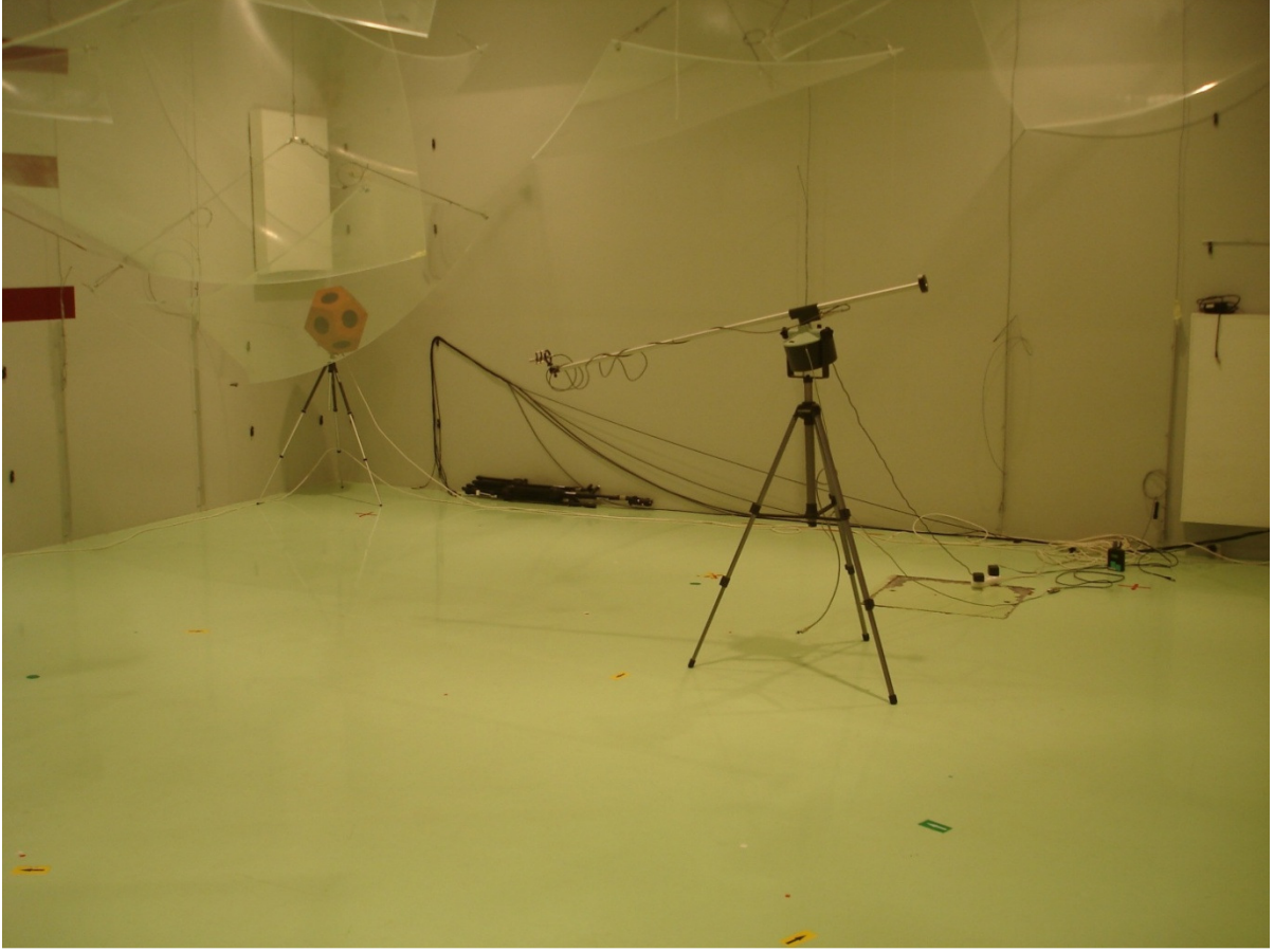
Şekil 3. Ölçüm düzeneğinin oda içerisindeki ve mikrofonun döner kol üzerindeki yerleşimi
