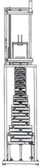
Şekil 1. Ölü ağırlıklı kuvvet kalibrasyon makinası
