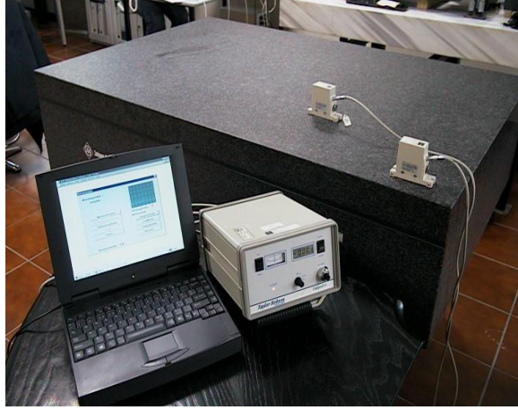
Şekil 1. Elektronik eğim ölçer ile granit masa kalibrasyonu
