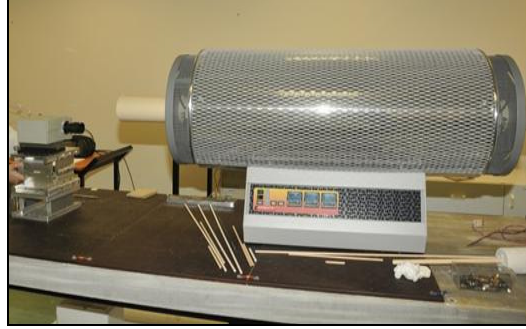
Şekil 1. Yüksek sıcaklık fırını ölçüm düzeneği
