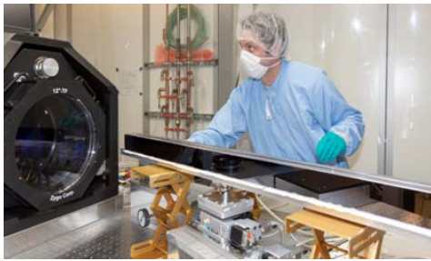
X ışınlarının yönlendirilmesinde kullanılan ultra hassas optik ayna (500 000 Euro)
