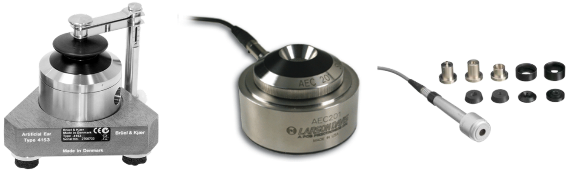
Şekil 1. Ticari olarak temin edilebilen yapay kulak [7,8] ve kulak simülatörü [9] örnekleri
