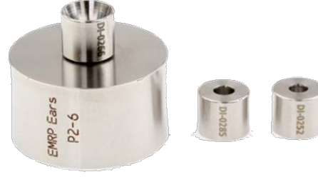
Şekil 3. EARS projesi kapsamında geliştirilmiş kulak simülatörü prototipi [10]
