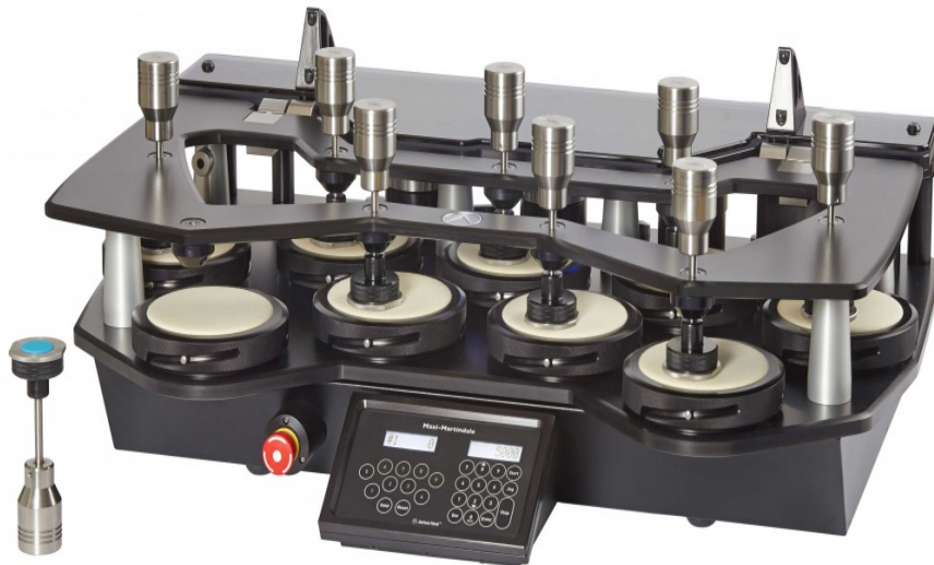
Şekil 1: Martindale Aşınma ve Boncuklanma Test Cihazı
