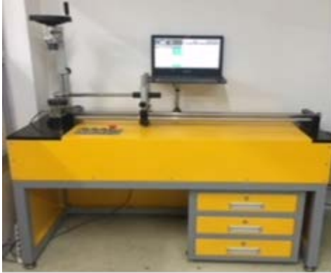
Şekil 2. 1000N·m Tork El Aletleri Kalibrasyon Sistemi resmi
