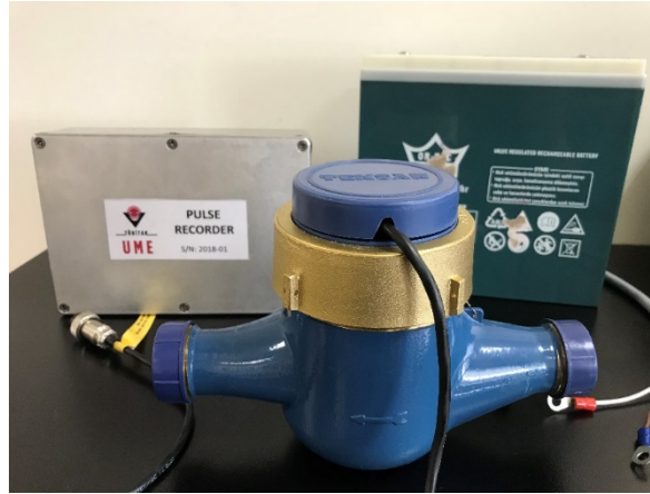
Şekil 1. Ölçümlerde kullanılan su sayacı ve elektronik kısmı.
