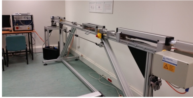
Şekil 3. Şok dönüştürücüler için birincil kalibrasyon sistemi
