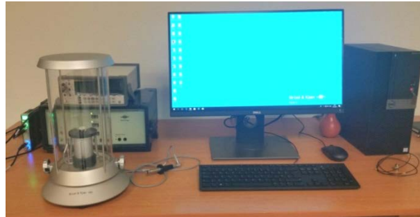
Şekil 1. Laboratuvar standardı mikrofonların karşılıklık yöntemine göre basınç kalibrasyonu sistemi
