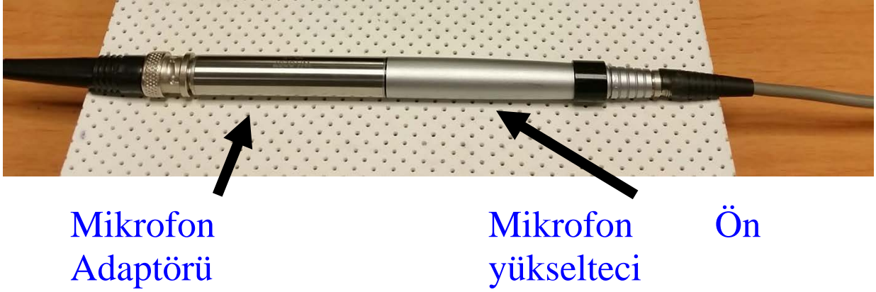
Şekil 4. Frekans tepkisi ölçümleri için mikrofon adaptörü ve ön yükseltecin bağlı olduğu durum
