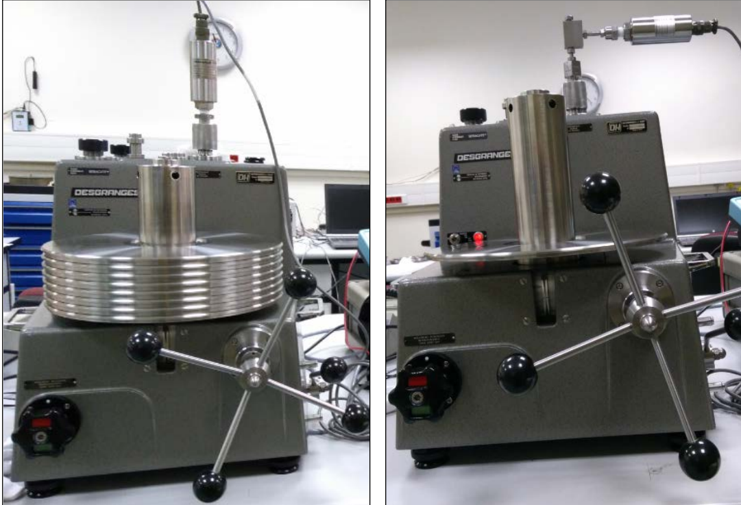
Şekil 3. Dikey ve yatay bağlantılı ölçüm düzeneği
