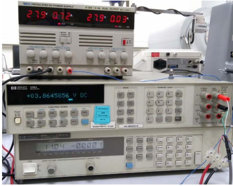
Şekil 4. Hassas multimetre, 11 V besleme kaynağı ve 28 V besleme kaynağı
