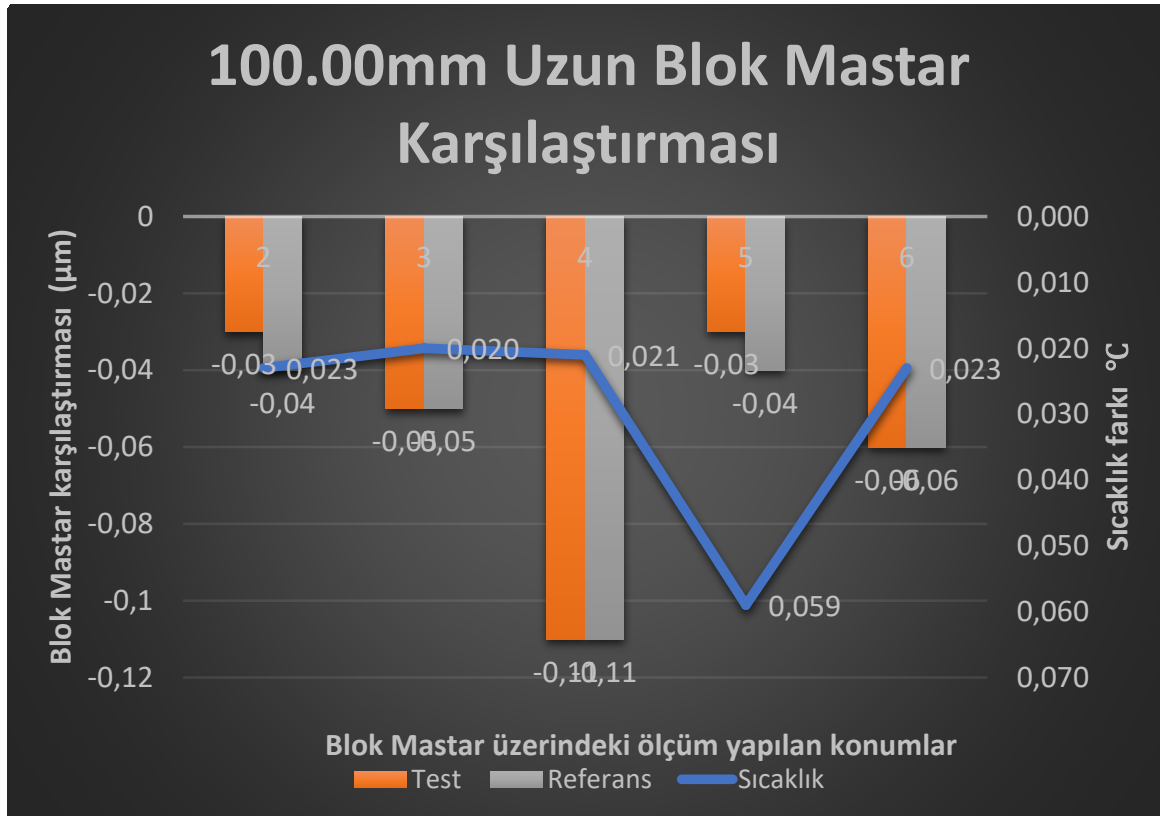
Grafik 2. 100 mm uzun blok master karşılaştırması yukarıdaki ölçümde yer alan referans masterla test master yer değiştirmiştir.
