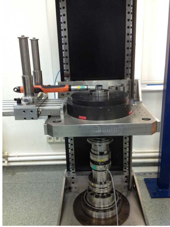
Resim 3. 1000 N·m 'lik Referans Tork Dönüştürücülü Tork Kalibrasyon Makinası
